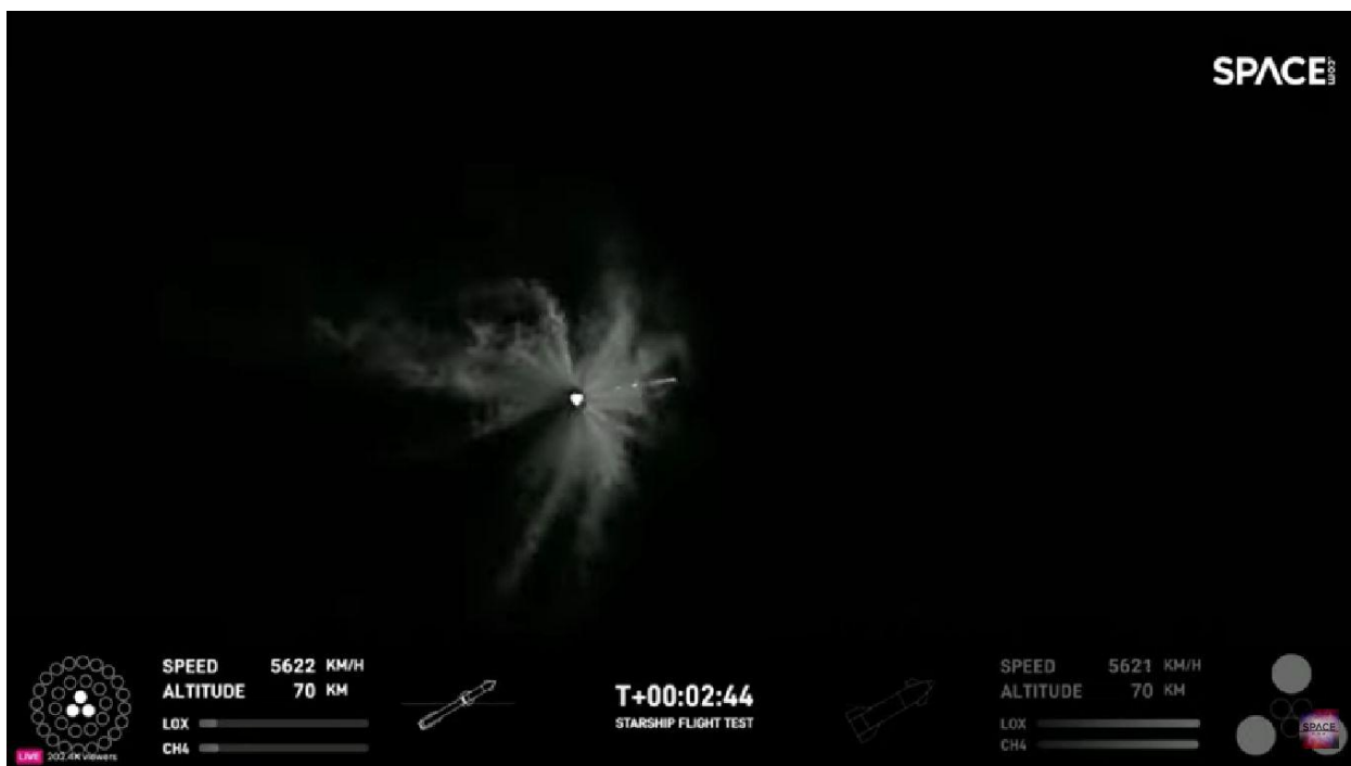
Рис. 6 – Сброс газов наддува из топливных баков перед началом разделения ступеней
