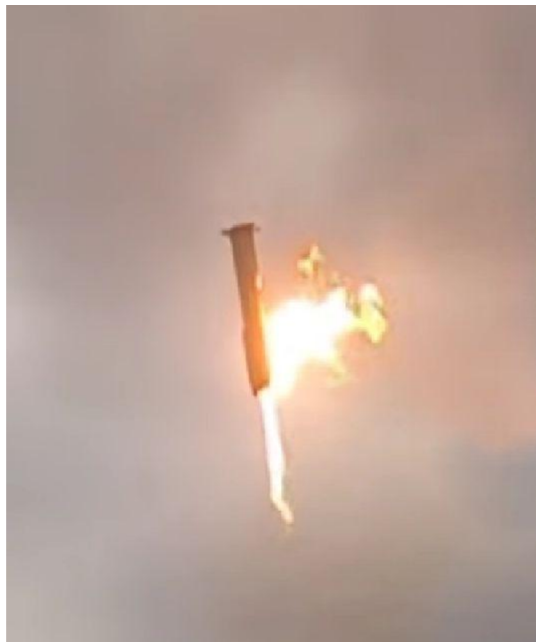
Рис. 4 – Пожар на бустере B11 перед приводнением
