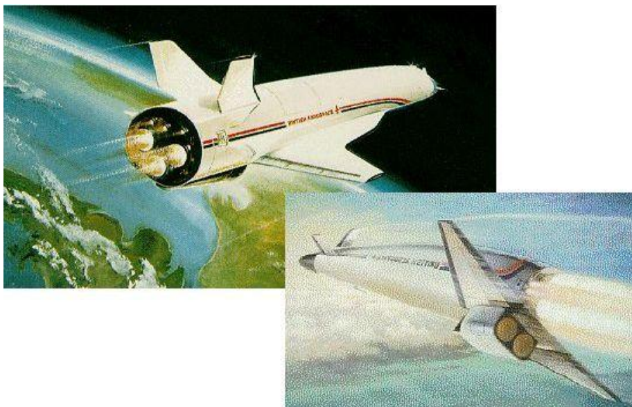
Рис. 9 – Исходная (снизу) и финальная (сверху) компоновки орбитального самолета Hotol
