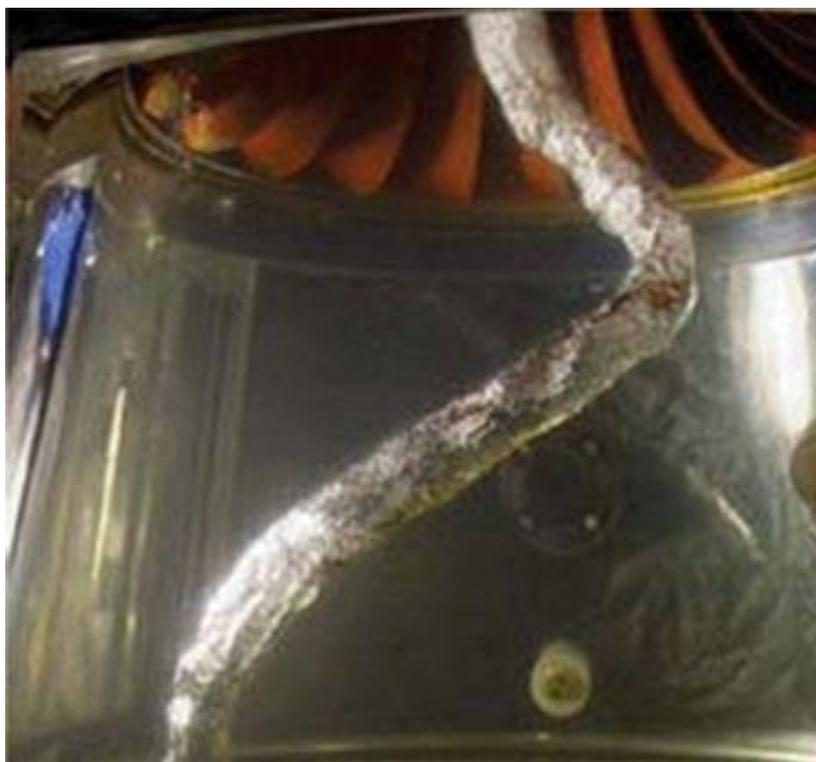
**Рис. 8 – Затурбинный вихревой жгут**
