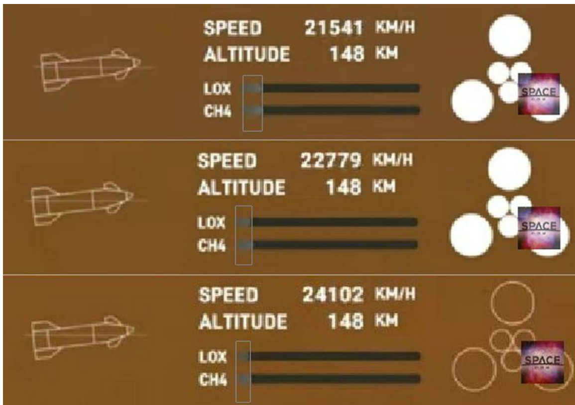
Рис. 2 – Количество компонент топлива в баках второй ступени в моменты времени 463, 473 и 483 (с) (сверху вниз)
