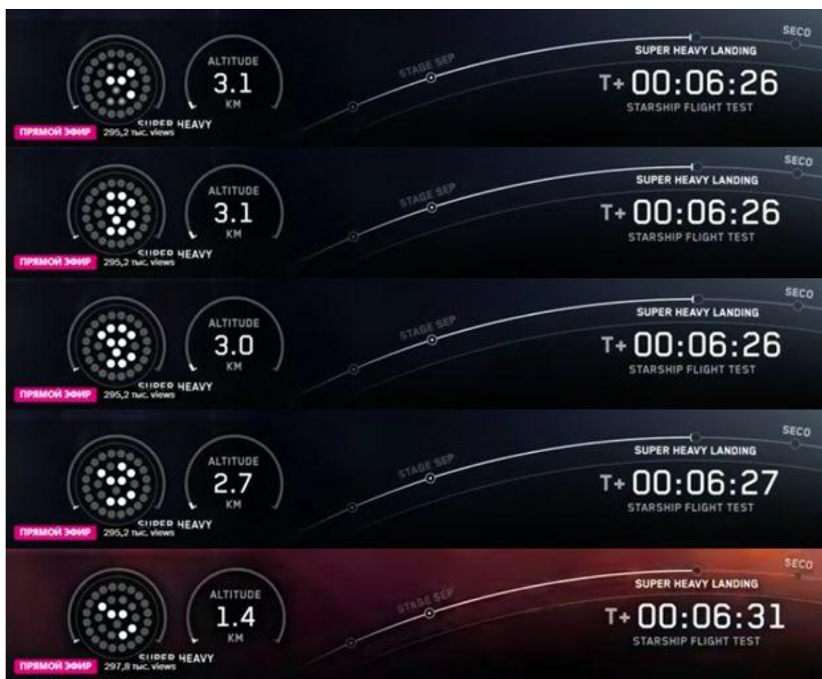
Рис. 5 – Включения и выключения двигателей бустера B20 при его попытке посадки [16]
