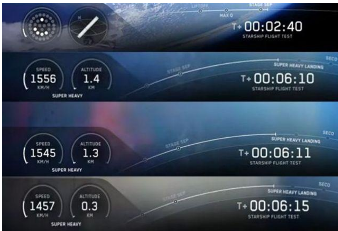
Рис. 2 – Траекторные и иные данные в моменты попыток бустбэка и посадочного торможения бустера B19 [13]
