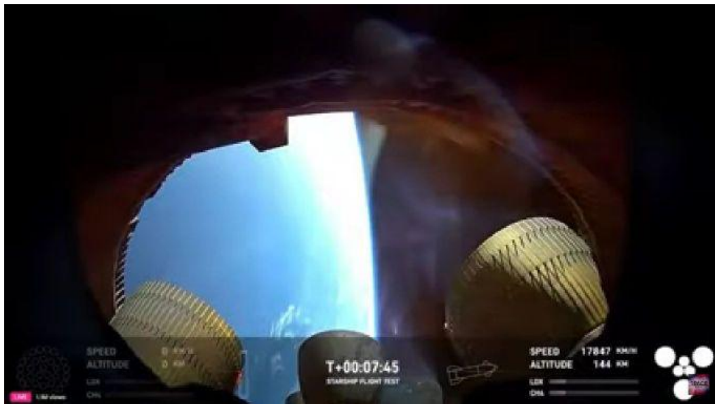
Рис. 8 – Отблеск на обресе хвостового отсека корабля от короткого всполоха пламени в его верхней части при IFT-8
