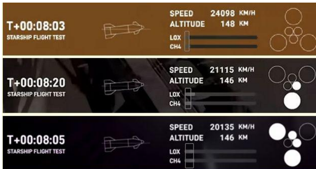
Рис. 10 – Соотношение долей кислорода и метана в баках кораблей Ship при IFT-2, IFT-7 и IFT-8 в кульминационные моменты трех аварий
