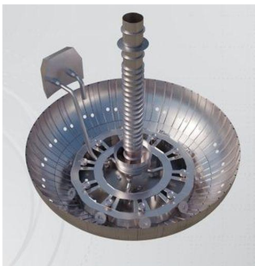
Рис. 2 – Рендер нижней части кислородного бака бустера SH7+ версии V1 с нижним участком центральной трубы для подачи метана [8]
