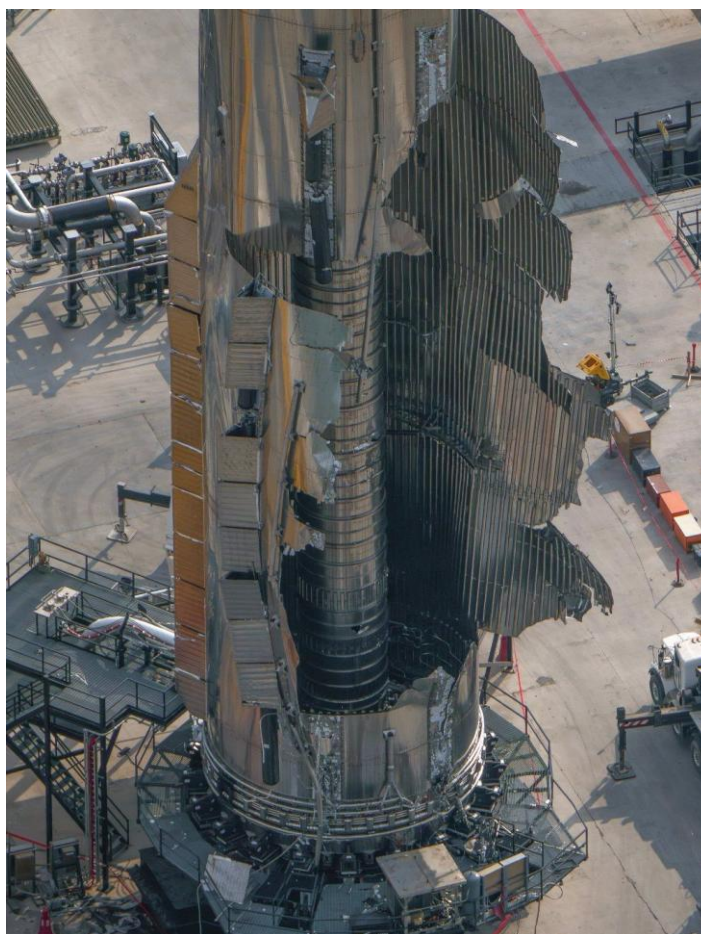
Рис. 1 – Общий вид внутренностей бустера SH18 (B18) – первого экземпляра новой версии V3 после неудачных криогенных испытаний [7]
